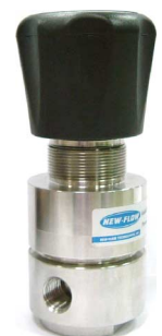
fig 935 inox drukreducerventiel PRU PN240 / 3500psi 1/4" - 1/2" npt huis : inox 316 temp. : -40°C +175°C voorzien van manometers type PRU-100 1/4"npt instelbaar : 0,07-3,4 bar/ 0,2-17 bar/ 0,35-34 bar type PRU-200 1/2"npt instelbaar : 0,2-17 bar / 0,35-34 bar
