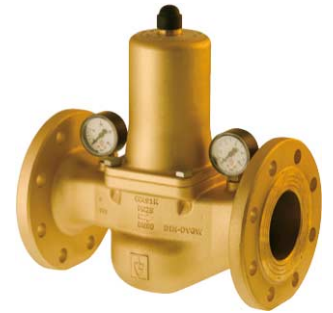
fig 923 bronzen drukreducerventiel PN16 DN20 - DN80 flens PN16 huis : brons CC491K voorzien van inox filterzeef temp. : max. +95°C max. voordruk P1 : 25 bar instelbereik : 1,0 - 7,0 bar geleverd met manometer geschikt voor lucht en niet-corrosieve vloeist.
