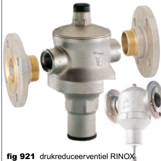
fig 921 drukreducerventiel RINOX DN25 - DN100 flens PN16 huis : messing vernikkeld / zitting : inox 304 O-ring : NBR / membraan : EPDM / veer staal temp. : max. +80°C max. voordruk P1 : 25 bar instelbereik tot 1" : 0,8 - 5,5 bar instelbereik >1" : 0,8 - 7,0 bar draadflenzen niet gemonteerd geleverd
