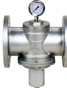
fig 926 inox drukreducerventiel PRV DN15 - DN100 flens PN16 huis : inox 316 (CF8M) voorzien van manometer dichtingen in viton temp. : -15°C +100°C max. druk P1 : 16 bar instelbaar : 1,0- 6 bar / 4,0- 10 bar / 8- 13 bar
