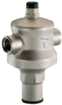
fig 920 drukreducerventiel RINOX 1/2" - 4" bsp huis : messing vernikkeld / zitting : inox 304 O-ring : NBR / membraan : EPDM / veer staal temp. : max. +80°C max. voordruk P1 : 25 bar instelbereik tot 1" : 0,8 - 5,5 bar instelbereik >1" : 0,8 - 7,0 bar geschikt voor lucht en niet-corrosieve vloeist.
