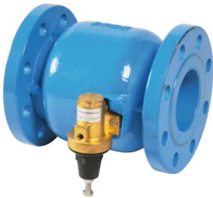
fig 928 drukreducerventiel BFR PN16 DN50 - DN300 flens huis : gietier met epoxy coating brons/messing binnenwerk voorzien van manometer dichtingen in NBR temp. : -10°C +80°C max. druk P1 : 16 bar instelbaar : 1,0- 7 bar / 4,0- 12 bar
