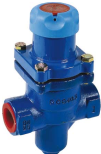
fig 930 stoomdrukreducerventiel PN25 1/2" - 1" bsp typd BDV25 geschikt voor stoom - lucht - gassen huis : nod. gietijzer GGG40.3 inox binnenwerk ingebouwde filter temp. : max. +210°C max. druk P1 : 17 bar instelbaar : 0,14 - 1,7 / 1,4 - 4,0 / 3,5 - 8,6 bar
