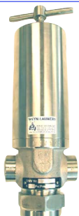
fig 933 inox drukreducerventiel 3/8" - 2" bsp huis : inox 316TI (1.4301 / 1.4571) inox binnenwerk temp. : -50°C +150°C mogelijk druk : tot 200 bar mogelijk instelbaar : vanaf 0,05 - 200 bar mogelijk beschikbare dichtingen : NBR / FPM / EPDM PTFE / PA6
