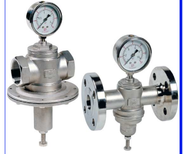
fig 925 inox drukreducerventiel LPRV PN10 1/2" - 2" bsp huis : inox 316 (CF8M) voorzien van manometer dichtingen in viton temp. : -15°C +80°C max. druk P1 : 16 bar instelbaar : 0,2- 1,5 bar fig 927 idem voorzien van flenzen PN16
