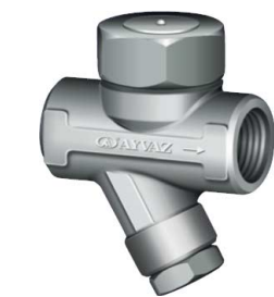
fig TDK71 thermodynamische condenspot PN63 1/2" - 1" bsp huis : inox A743 inox binnenwerk voorzien van Y-filter druk P2 : max. 80 % van druk P1 temp. : max. +400°C max. druk P1 : 42 bar horizontale montage
