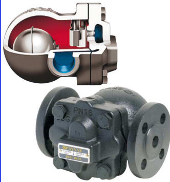
fig SK51 vlotter-condenspot PN16 1/2" - 1" bsp / DN15 - DN25 flens huis : nodulair gietijzer GGG40.3 inox vlotter en binnenwerk temp. : max. +250°C ingebouwde thermostatische ontlufter delta P : 4,5 bar / 10 bar / 14 bar horizontale montage
