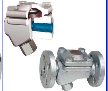
fig TKK2Y thermostatische condenspot PN40 1/2" - 1" bsp / DN15 - DN25 flens huis : staal A105 inox/hastelloy binnenwerk voorzien van Y-filter max. druk P1 : 32 bar max. verschildruk delta P : 22 bar temp. : max. +250°C horizontale montage
