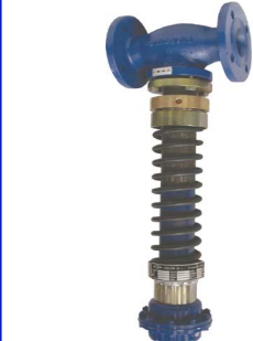
fig 934 drukreduceerventiel DRP40 DN40 - DN100 flens PN40 huis : staal / balg : inox temp. : max. +215°C max. druk P1 : 20 bar max. verschildruk delta P : 10 bar instelbaar : 0,2 - 1,5 bar / 1 - 4 bar 1,2 - 6,0 bar / 1 - 10 bar 8,0 - 13 bar
