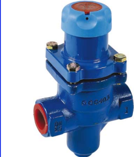
fig 930 drukreduceerventiel PN25 1/2" - 1" bsp type BDV25 geschikt voor stoom - lucht - gassen huis : nod. gietijzer GGG40.3 inox binnenwerk ingebouwde filter temp. : max. +210°C max. druk P1 : 17 bar instelbaar : 0,14 - 1,7 / 1,4 - 4,0 / 3,5 - 8,6 bar
