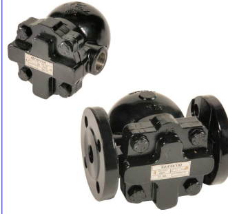
fig SK70 stalen vlotter-condenspot PN25 1/2" - 1" bsp / DN15 - DN25 flens huis : staal A216WCB inox vlotter en binnenwerk temp. : max. +400°C ingebouwde thermostatische ontlufter delta P : 4,5 bar / 10 bar / 14 bar horizontale montage
