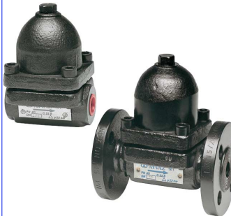
fig TK1 bi-metaal condenspot PN40 1/2" - 1" bsp / DN15 - DN25 flens huis : staal A105 inox binnenwerk voorzien van Y-filter en terugslagklep max. druk P1 : 32 bar max. verschildruk delta P : 22 bar temp. : max. +250°C montage in elke positie
