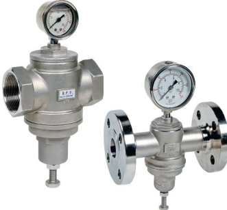
fig 931 inox drukreduceerventiel 1/2" - 1" bsp type PRV-S voorzien van manometer diam. 63 mm huis : inox 316 (CF8M) dichtingen in viton/teflon druk P2 : max. 80 % van druk P1 temp. : max. +192°C / max. druk P1 : 12 bar instelbaar : 1,0 - 6 bar / 4,0 - 10 bar fig 932 idem met flenzen PN16
