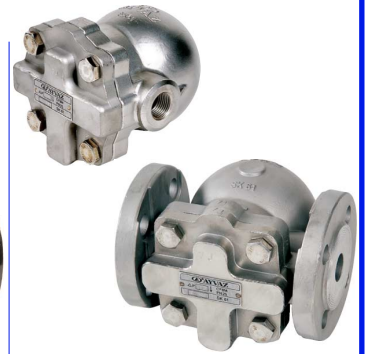
fig SK70 inox vlotter-condenspot PN25 1/2" - 1" bsp / DN15 - DN25 flens huis : inox 316 (CF8M) inox vlotter en binnenwerk temp. : max. +250°C ingebouwde thermostatische ontlufter delta P : 4,5 bar / 10 bar / 14 bar horizontale montage
