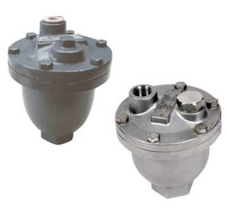
ontlueters 3/4" bsp fig PF20 : huis in gietijzer max. druk : 10 bar temp. : max. +120°C fig AV02 : huis in inox max. druk : 12 bar temp. : max. +200°C
