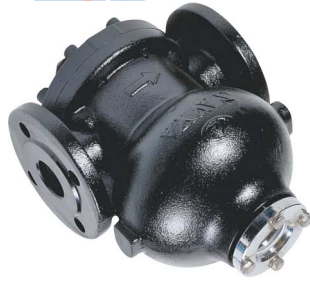
fig SK55 vlotter-condenspot PN16 DN32 - DN50 flens huis : nodulair gietijzer GGG40.3 inox vlotter en binnenwerk temp. : max. +250°C voorzien van borosilicaat kijkglas ingebouwde thermostatische ontlufter delta P : 4,5 bar / 10 bar / 14 bar horizontale montage
