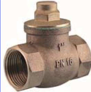
bronzen terugslagklep PN16 met inox veer teflon klepafdichtingsring temp. : -10°C +200°C fig 716 : FF 3/8" - 2" bsp
