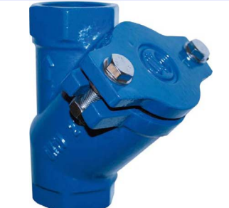
nodulair gietijzeren balkeerklep PN10 huis : GGG40 fig 770 FF 1" - 3" bsp bal NBR rubber tot 6/4" bal aluminium met NBR coating > 6/4" temp. : -30°C +180°C
