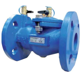
BELGAQUA gekeurde terugslagklep PN10 EA terugstroombeveiliging DN40 - DN250 huis gietijzer met epoxy coating 2 boringen met controlekraan 1/2" behalve DN40/50 : 1/4" 1 boring met leegloopstop 1/2" behalve DN40/50 : 1/4" temp. : max +100°C
