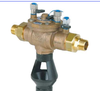
BELGAQUA gekeurde terugslagklep PN10 BA terugstroombeveiliging MM 1/2" - 2" bsp huis messing ontlastklep : polymer PA kleppen : polymer POM temp. : max. +65°C
