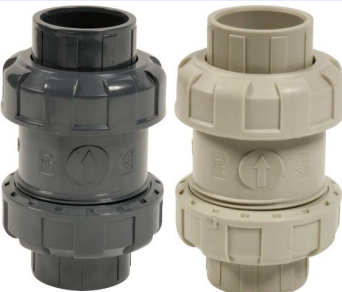
PVC / PP veerterugslagkleppen PN10 PVC uitvoering : max. +60°C / PP max. +80°C fig 730 : PVC/EPDM dichtingen / 1/2"-2" bsp fig 731 : PVC/EPDM dichtingen / 20-63 lijm fig 733 : PVC/VITON dichtingen / 1/2"-2" bsp fig 734 : PVC/VITON dichtingen / 20-63 lijm fig 740 : PP/EPDM dichtingen / 1/2"-2" bsp fig 741 : PP/EPDM dichtingen / 20-63 lijm fig 743 : PP/VITON dichtingen / 1/2"-2" bsp fig 744 : PP/VITON dichtingen / 20-63 lijm
