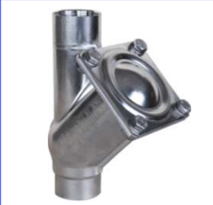
inox balkeerklep PN16 huis inox 316 fig 773 : FF 5/4" - 2" bsp bal aluminium met viton coating temp. : -30°C +180°C fig 774 : FF 5/4" - 2" bsp bal aluminium met NBR coating temp. : -30°C +90°C
