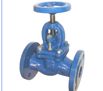
fig 490 : vergrendelbare terugslagklep PN16 DN15 - DN3000 huis : gietijzer bronzene klepafdichting en zitting stijgende spindel en handwiel temp. : max -10°C +225°C inbouw lengte volgens din 3202 F1 spindel naar beneden gedraaid wordt de terugslagklep vergrendeld in gesloten stand
