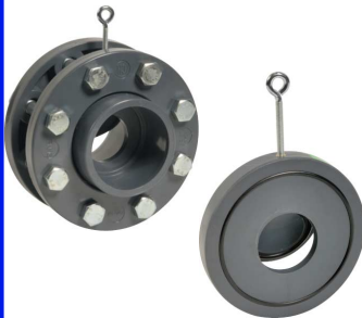
PVC tussenbouwtype PN10 PVC huis en flapper inox veer temp. : 0°C +60°C fig 736 : EPDM dichting / DN32 - DN150 fig 737 : VITON dichting / DN32 - DN150 met flenzen PN10 + lijmeinden fig 738 : EPDM dichting / DN32 - DN150 fig 739 : VITON dichting / DN32 - DN150
