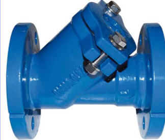
gietijzeren terugslagklep PN16 veerbelast / epoxy coating DN50 - DN300 fig 787 : gietijzeren disc NBR dichting temp. : -10°C +80°C fig 787T : inox 304 disc EPDM dichting temp. : -10°C +110°C
