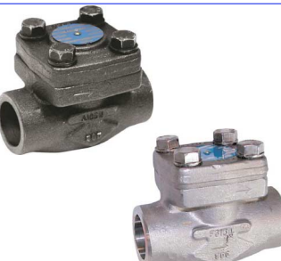
terugslagkleppen ANSI 800 lbs piston type fig 721.1 : staal 3/8" - 2" npt fig 721.1bsp : staal 3/8" - 2" bsp fig 724.1 : staal 3/8" - 2" SW-laseinden bal type fig 722.1 : staal 3/8" - 2" npt fig 725.1 : staal 3/8" - 2" SW-laseinden fig 721.3 : inox 316 / 3/8" - 2" npt fig 725.3 : inox 316 / 3/8" - 2" SW-laseinden
