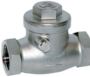
messing terugslagklep PN10 met flapper / zonder veer fig 711 : FF 3/8" - 4" bsp rubber beklede klep 3/8" - 2" : met EPDM rubber / -10°C +90°C 2 1/2" - 4" : met NBR rubber / -10°C +80°C fig 710 : FF 3/8"-4" bsp metaal/metaal dichtend fig 710NPT / fig 711NPT : met NPT draad
