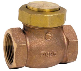
bronzen terugslagklep PN25 met inox veer inox klep en klepzitting temp. : -10°C +200°C fig 717 : FF 1/4" - 2" bsp
