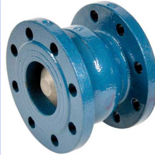
gietijzeren terugslagklep PN16 veerbelast / epoxy coating DN50 - DN300 fig 787 : gietijzeren disc NBR dichting temp. : -10°C +80°C fig 787T : inox 304 disc EPDM dichting temp. : -10°C +110°C
