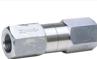
inox terugslagklep PN16 met flapper / zonder veer fig 712 : FF 1/2" - 2" bsp teflon klepring temp. : -30°C +180°C max. 16 bar bij 120°C max. 10 bar bij 180°C fig 712NPT : met NPT draad
