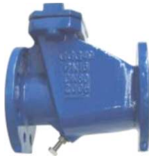
nodulair gietijzeren terugslagklep PN10/16 met NBR rubber flapper / zonder veer fig 752 : DN40 - DN400 NBR rubberen klep temp. : -10°C +80°C inbouw lengte volgens DIN 3202 F6 flenzen volgens PN16 RF huis : nodulair gietijzer GGG40 / GJS400
