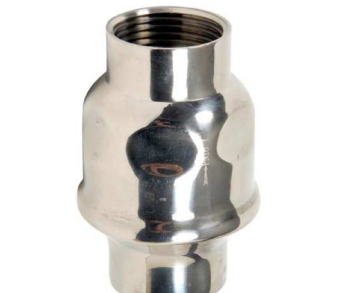
inox terugslagklep PN16 met inox veer inox klep en viton klepzitting temp. : -10°C +150°C FF 1/4" - 4" bsp fig 713 : in inox 304 fig 714 : in inox 316
