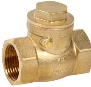
messing terugslagklep PN10 met flapper / zonder veer fig 711 : FF 3/8" - 4" bsp rubber beklede klep 3/8" - 2" : met EPDM rubber / -10°C +90°C 2 1/2" - 4" : met NBR rubber / -10°C +80°C fig 710 : FF 3/8"-4" bsp metaal/metaal dichtend fig 710NPT / fig 711NPT : met NPT draad
