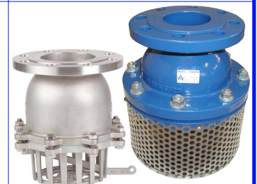
voetkleppen met filterzeef PN16 fig 795 : gietijzeren huis / stalen zeef temp. : -10°C +90°C PN16 : DN50 - DN300 fig 797 : inox 316 huis en zeef temp. : -25°C +150°C PN16 : DN50 - DN200 manueel leegloop-hendel viton zitting / telfon dichtingen
