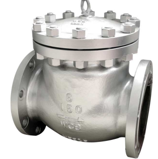
stalen terugslagklep met flapper / zonder veer ANSI huis : ASTM A216 WCB temp. : -20°C +400°C volgens ASTM A182 / trim F6 fig 758 : ansi 150 lbs / 2" - 12" fig 759 : ansi 300 lbs / 2" - 12"
