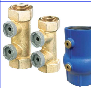
BELGAQUA gekeurde terugslagklep PN10 EA keerkleppen pollustop : FF 1/2" - 2" bsp in messing FF 2 1/2" - 3" bsp in gietijzer messing : temp. : max +80°C gietijzer : temp. : max +100°C 2 afgeplugde boringen veer in inox
