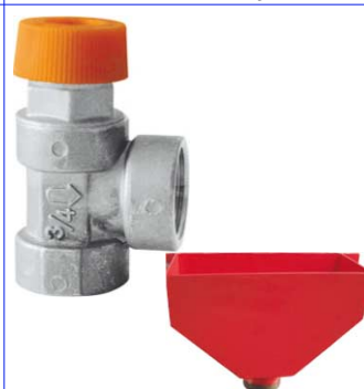
fig 911 messing veiligheidsklep 1/2" in - 3/4" uit bsp max. temp. : +110°C vooringesteld op : 3 of 6 bar zonne-verwarminginstallaties
