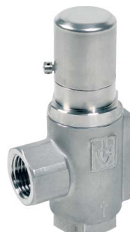
fig 902 inox overstortventiel 3/8" - 5/4" bsp huis : inox 316 (CF8M) / gesloten kap viton zitting max. druk : 30 bar / temp. : -10°C/+200°C insteldruk : 1,2 - 3,0 bar 2 - 12 bar
