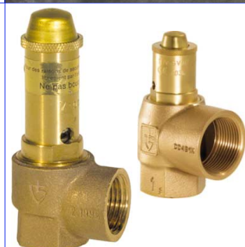
fig 912 bronzen veiligheidsklep vooringesteld / voor CV en warm water 1/2" - 2" bsp vooringesteld op : 3 / 4 / 5 / 7 / 10 bar
