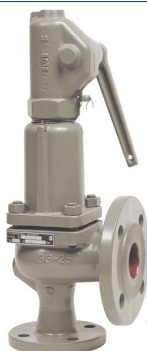
fig 1401 geflensd veiligheidsventiel PN16 DN20 tot DN150 huis : gietijzer GG20 / met kleplicher gesloten kap / inox zitting temp. : -10°C +200°C min. afsteldruk 0,5 bar bureau veritas marine/offshore gekeurd
