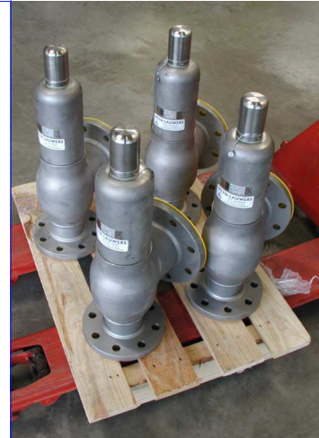
fig 905 inox veiligheidsklep 3/8" - 2" bsp MM huis : inox 316 teflon zitting temp. : -10°C/+200°C insteldruk : 0,5 - 12 bar (elke 0,5 bar)
