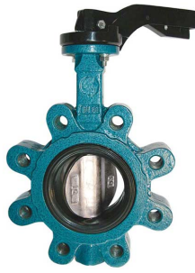
fig 250 lug type PN10/16 huis gietijzer + epoxy coating vlinder nodulair gietijzer vernikkeld dichting EPDM DN40 - DN300 temp. : -20°C/+120°C voorzien van iso 5211 topflens wormwielkast op aanvraag ge Vulcaniseerde dichting
