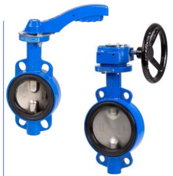
fig 200 wafer type PN10/16 ansi 150 lbs huis gietijzer + epoxy coating vlinder nodulair gietijzer vernikkeld vlinder en as RVS316 DN50 - DN500 temp. : -20°C/+120°C voorzien van iso 5211 topflens wormwielkast vanaf DN300
