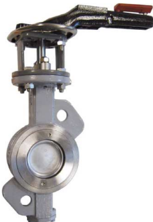
fig 234/235 wafer type PN25 dubbel excentrische uitvoering vlinder en as RVS316 dichting PTFE + 15% grafiet DN50 - DN350 temp. : -20°C/+210°C voorzien van iso 5211 topflens wormwielkast op aanvraag fig 234 : huis staal / fig 235 : huis RVS316
