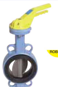
fig 205B gas wafer PN10/16 ansi 150 lbs huis nodulair gietijzer + epoxy coating vlinder nodulair gietijzer dichting NBR DN32 - DN200 temp. : -20°C/+80°C voorzien van iso 5211 topflens
