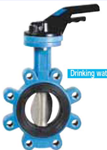
fig 265 lug type PN10/16 huis nodulair gietijzer + epoxy coating vlinder en as RVS316 dichting EPDM DN40 - DN400 temp. : -20°C/+120°C voorzien van iso 5211 topflens wormwielkast op aanvraag verwisselbare dichting
