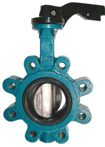
fig 260 lug type PN10/16 huis gietijzer + epoxy coating vlinder en as RVS316 dichting EPDM DN40 - DN300 temp. : -20°C/+120°C voorzien van iso 5211 topflens wormwielkast op aanvraag ge Vulcaniseerde dichting
