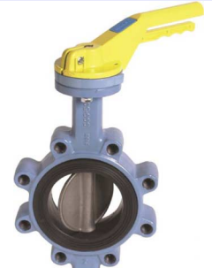
fig 265B gas lug type PN10/16 huis nodulair gietijzer + epoxy coating vlinder nodulair gietijzer dichting NBR DN40 - DN200 temp. : -20°C/+80°C voorzien van iso 5211 topflens
