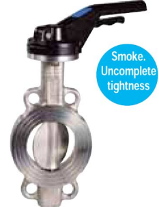
fig 231/233 wafer type PN10/16 ansi 150 lbs voor rookgassen tot 350°C sluit niet 100% af vlinder en as RVS316 DN32 - DN200 fig 231 : huis RVS316 fig 233 : huis staal A213WCB voorzien van iso 5211 topflens
