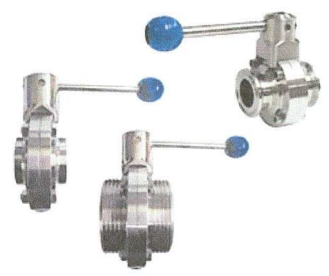
sanitaire vlinderkleppen huis en vlinder inox dichting EPDM aansluitingen 1" - 4" : las/las draad/draad DIN 11851 las/draad DIN 11851 clamp/clamp
