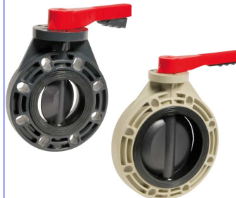
fig 241/242/243/244 wafer type PN10 fig 241 : PVC huis en vlinder / EPDM dichting fig 242 : PVC huis en vlinder / VITON dichting fig 243 : PP huis en vlinder / EPDM dichting fig 244 : PP huis en vlinder / VITON dichting PVC max 60°C / PP max 80°C DN 40 - DN300 ABS hendel
