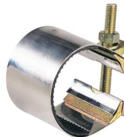
fig 997 reparatiekoppeling met 1 bout voor buis diam. 21 - 173 mm huis : inox lengte 80 mm dichting : EPDM temp. : -10°C/+60°C stalen bout en moer
