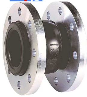
fig 971 rubber compensator PN10 DN32 - DN800 stalen gegalvaniseerde flenzen PN10 balg : EPDM rubber temp. : -10°C/+110°C fig 971.16 flenzen geboord volgens PN16 fig 971.150 flenzen geboord ansi 150 lbs
