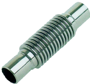
fig 975 inox compensator PN10 BW laseinden DN40 - DN200 inox 304 balg en inwendige liner inox 304 laseinden temp. : -10°C/+300°C stijgende spindel en handwiel temp. : -20°C/+300°C
