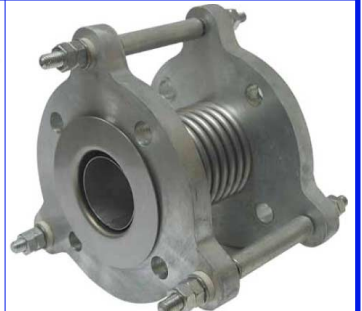
fig 974 inox compensator pn16 DN 25 - DN 200 stalen flenzen PN16 inox 321 balg en inwendige liner flenzen voorzien van uitzettingsbegrenzers temp. : -20°C/+300°C
