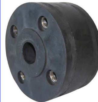
fig 979 schok- en geluidsdemper PN10 DN 80 - DN 600 huis : EPDM rubber lug type met stalen inwendige draadmoeren temp. : -10°C/+100°C
