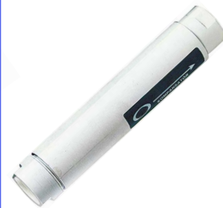
fig 977 inox compensator PN16 1/2" - 2" bsp huis : aluminium inox 316 balg en inwendige liner temp. : -20°C/+300°C
