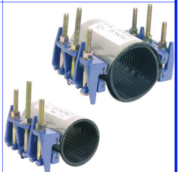
fig 998 reparatiekoppeling met 3 bouten voor buis diam. 48 - 285 mm huis : inox lengte 200 mm dichting : EPDM / clamp nodulair gietijzer temp. : -10°C/+60°C fig 999 reparatiekoppeling met 2 x 3 bouten voor buis diam. 88 - 516 mm
