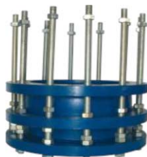
fig 982 uitbouwstuk PN 25 DN 80 - DN 600 huis : nodulair gietijzer, met epoxy coating stalen stangen en moeren flenzen geboord volgens PN 25 temp. : 0°C/+90°C fig 983 uitbouwstuk PN 40
