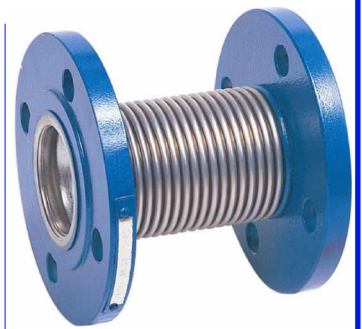
fig 973 inox compensator pn16 DN25 - DN250 1/2" - 2" bsp stalen flenzen PN16 inox 321 balg en inwendige liner temp. : -20°C/+300°C
