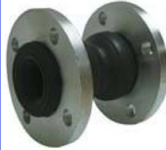
fig 972 rubber compensator PN10 DN50 - DN300 stalen gegalvaniseerde flenzen PN10 dubbele balg : EPDM rubber temp. : -10°C/+110°C
