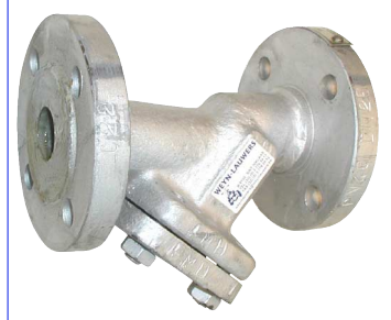
stalen ANSI Y-filters inox zeef huis : ASTM A216"WCB temp. : -20°C +400°C fig 808 : ansi 150 lbs / 2" - 12" fig 809 : ansi 300 lbs / 2" - 12"
