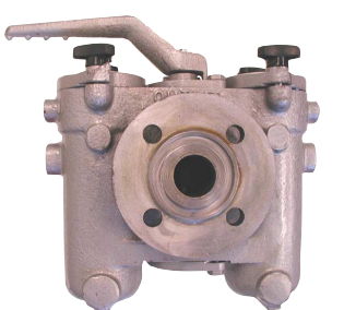
wisselfilter PN16 huis in gietijzer zeven in inox fig 834 : DN25 - DN150 flenzen volgens PN16
