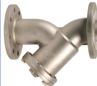
inox 316 Y-filter PN16 huis : en zeef : inox 316 fig 807 : DN15 - DN200 temp. : -20°C +200°C max. druk 16 bar inbouw lengte volgens din 3202 F1 zeef DN15 - DN50 : 0,8 mm zeef DN65 - DN80 : 1,0 mm / 3,0 mm >DN80
