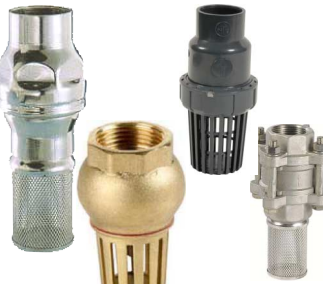
voetkleppen met filterzeef fig 791 : messing/NBR : FF 1/2" - 4" bsp temp. : 0°C +90°C fig 792 : inox/inox : FF 3/8" - 4" bsp veer 3-delig huis / temp. : -30°C +200°C fig 793 : inox/viton : FF 1/2" - 4" bsp veer temp. : -25°C +150°C fig 732 : PVC/EPDM : 20-63 mm lijmeinden veer temp. : 0°C +60°C
