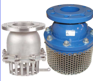
voetkleppen met filterzeef PN16 fig 795 : gietijzeren huis / stalen zeef temp. : -10°C +90°C PN16 : DN50 - DN300 fig 797 : inox 316 huis en zeef temp. : -25°C +150°C PN16 : DN50 - DN200 manueel leegloop-hendel viton zitting / teflon dichtingen
