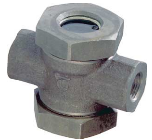
fig 864 stalen kijkglas 1/2" - 1" bsp huis : staal A105 dubbel borosilicaat glas max. druk 40 bar voor 1/2" en 3/4" max. druk 20 bar voor 1" temp. : -10°C +180°C
