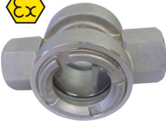
fig 866 inox kijkglas met flapper 1/2" - 2" bsp huis : inox 316 (CF8M) flapper : inox 316 (CF8M) dubbel getemperd glas temp. : -20°C +180°C max. druk 16 bar fig 866NPT met NPT schroefdraad
