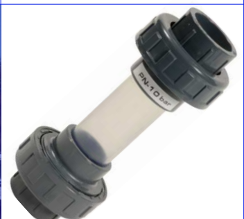
fig 857 PVC kijkglas met lijmeinden 20 tot 110 mm PVC huis en koppelingen transparante PVC buis temp. : 0°C +60°C max. druk 10 bar
