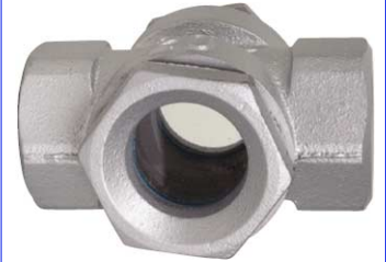
fig 862 gietijzeren kijkglas met flapper 1/2" - 2" bsp huis : gietijzer GG20 flapper in inox 304 dubbel getemperd glas temp. : -10°C +180°C max. druk 16 bar
