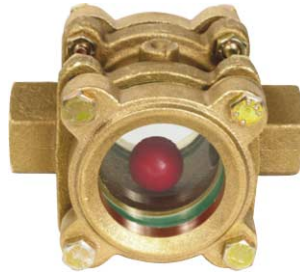
fig 860 kijkglas met kunststof bal 1/2" - 1" bsp / huis in brons CC491K 5/4" - 2" bsp / huis in messing CB754S dubbel getemperd glas temp. : +5°C +80°C max. druk 16 bar
