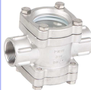
fig 885 inox kijkglas 1/2" - 2" bsp huis : inox 316 (CF8M) dubbel kijkglas max. druk 16 bar bij +50°C max. temp. +200°C bij 10 bar
