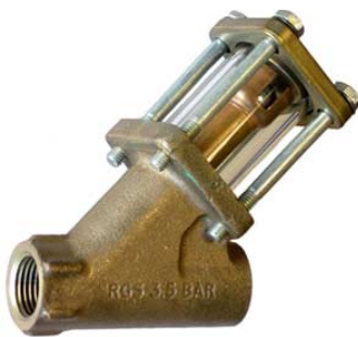
HILLS kijkglas/terugslagklep met kogel 1/2" - 1" bsp fig 858 huis : brons venster borosilicaat glas max. druk : 3,6 bar max. temp. +148°C
