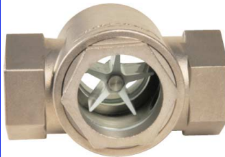
fig 865 inox kijkglas met rotor 1/2" - 2" bsp huis : inox 316 (CF8M) rotor in ABS dubbel getemperd glas temp. : -10°C +90°C max. druk 10 bar
