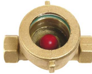
fig 860 kijkglas met kunststof bal 1/2" - 1" bsp / huis in brons CC491K enkel getemperd glas temp. : +5°C +80°C max. druk 16 bar
