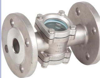
fig 887 inox kijkglas PN16 DN15 - DN100 huis : inox 316 (CF8M) dubbel kijkglas max. druk 16 bar bij +50°C max. temp. +200°C bij 10 bar flenzen volgens PN16
