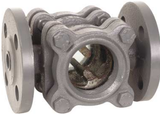
fig 863 gietijzeren kijkglas PN16 DN15 - DN100 huis : gietijzer GG20 dubbel getemperd glas temp. : -10°C +180°C max. druk 16 bar flenzen volgens PN16
