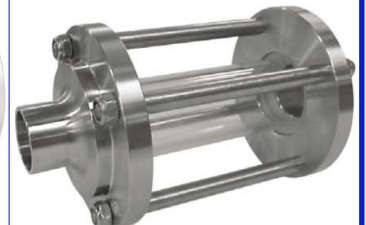
fig 868 inox kijkglas met laseinden 25 - 38 - 51 - 63 mm huis : inox 316L glasbuis BW- laseinden max. druk 10 bar max. temp. +140°C
