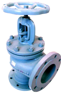
fig 434 klepafsluiter gietijzer PN16 DN 15 - DN 200 haaks
