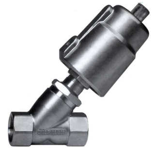
fig 5311I klepafsluiter inox pn16 pneumatisch enkelwerkend normaal gesloten 1/2" - 2" bsp
