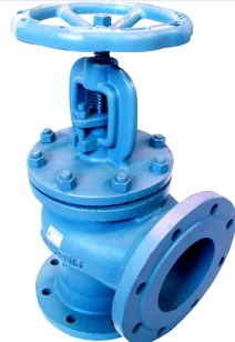
fig 454 klepafsluiter staal PN40 DN 15 - DN 200 haaks
