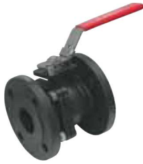
staal : PN16 volle doorlaat fig 164 : DN15-DN200 vergrendelbare hendel inox bol / PTFE dichtingen temp. : -40°C/+180°C voorzien van iso 5211 topflens inbouw lengte volgens DIN 3202 F4
