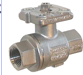
inox volle doorlaat fig 171VEGA 1/4"-1" bsp : PN140 1 1/4"-2" bsp : PN100 2 1/2"-3" bsp : PN64 voorzien van iso 5211-top flens voor rechtstreekse montage
