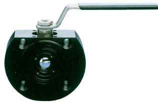
staal : PN16 volle doorlaat fig 181.1 : DN15-DN200 fire-safe dn DVGW-gas op aanvraag inox bol / PTFE dichtingen temp. : -20°C/+180°C voorzien van iso 5211 top-boringen
