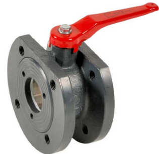
gietijzer PN16 volle doorlaat fig 181.0 : DN40-DN100 verchroomde messing bal PTFE dichtingen temp. : -10°C/+150°C
