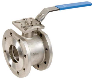
inox PN40 tot DN80 / >DN80 PN16 volle doorlaat PTFE dichtingen fig 181.3T : DN15-DN150 DN15 - DN50 : PN40 DN65 - DN150 : PN16 voorzien van iso 5211 topflens voor rechtstreekse montage temp. : -20°C/+180°C
