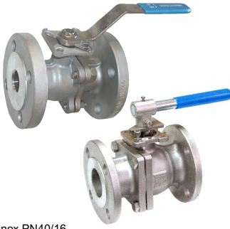
inox PN40/16 volle doorlaat PTFE + 15 % GF dichtingen fig 175 : DN15-DN200 DN15 - DN50 : PN40 DN65 - DN200 : PN16 voorzien van iso 5211 topflens voor rechtstreekse montage fig 175.40 : DN65-DN150 PN40
