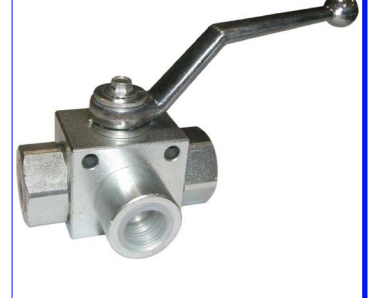
staal L-boring - gereduceerde boring fig 133 : 1/4"-3/8" bsp PN400 1/2"-1" PN350 -10 +100°C
