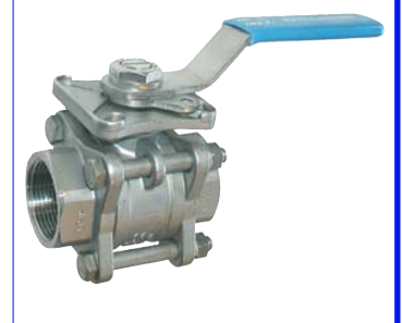
inox 3-delig - volle doorlaat fig 177 : PN63 1/4"-4" bsp fig 178 : PN63 1/4"-4" BW fig 177NPT : PN63 1/4"-4" npt fig 178SW : PN63 1/4"-4" SW voorzien van iso-5211 top flens voor rechtstreekse montage
