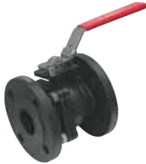
staal 150 lbs volle doorlaat fig 193 : 1/2" - 8" vergrendelbare hendel inox bol / PTFE dichtingen temp. : -40°C/+180°C voorzien van iso 5211 topflens inbouw lengte volgens ASME B16.10
