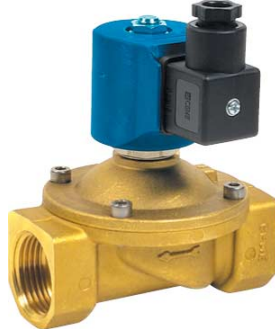
2-weg magneetventiel normaal gesloten directwerkend = geen verschilddruk nodig fig 623 : (VSO84) FF 3/8" - 2" bsp huis : messing NBR dichting temp. : -10°C +80°C 24 - 48 - 230 VAC / 12 - 24 VDC
