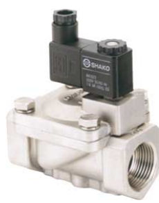
2-weg magneetventiel normaal gesloten minimum verschilddruk nodig : 0,5 bar fig 629 : (SPU225) FF 3/8" - 2" bsp huis : inox / viton dichting temp. : -10°C +90°C 24 - 48 - 230 VAC / 12 - 24 VDC fig 630 : (SPU225-X) FF 1/2" - 3/4" bsp Ex-uitvoering ATEX EEx m II 2G/D T4 voor zones 1, 21, 2 en 22
