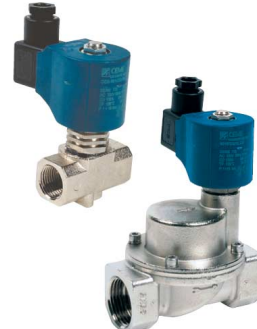
2-weg magneetventiel normaal gesloten minimum verschilddruk nodig : 1,0 bar fig 624 : (ESV80) FF 1/2" - 2" bsp huis : messing teflon dichting temp. : -40°C +180°C 24 - 48 - 230 VAC / 12 - 24 VDC
