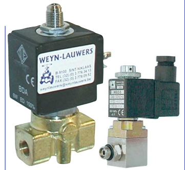
3-weg magneetventiel directwerkend = geen verschilddruk nodig fig 600 : FF 1/8" - 1/4" bsp huis : messing viton dichting temp. : -10°C +140°C 24 - 48 - 230 VAC / 12 - 24 VDC fig 601 : MF 1/8" bsp
