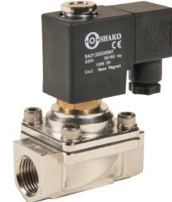
2-weg magneetventiel normaal gesloten directwerkend = geen verschilddruk nodig fig 627 : (SPU220) FF 1/2" - 3/4" bsp huis : inox / viton dichting temp. : -10°C +90°C 24 - 48 - 230 VAC / 12 - 24 VDC fig 628 : (SPU220-X) FF 1/2" - 3/4" bsp Ex-uitvoering ATEX EEx m II 2G/D T4 voor zones 1, 21, 2 en 22
