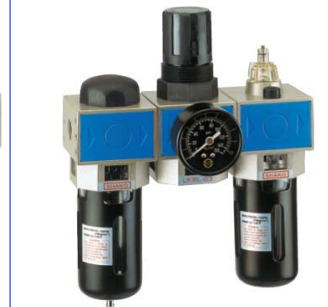
perslucht apparaat - combinaties fig 546 filter/olienevelaar/drukregelaar met manometer filter 40 micron 1/4" - 1" bsp temp. : 0°C/+50°C aluminium huis klokken in polycarbonaat / bescherming in glasvezel/nylon
