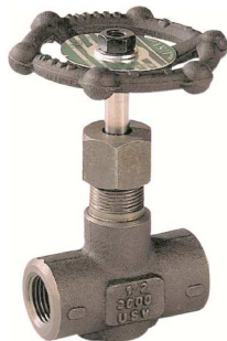
naaldventiel staal PN210 A105/F6 smeedstaal 1/4" - 1" ANSI 3000 lbs grafiet spindelafdichting / naald : inox 316 temp. : -20°C/+250°C fig 526 bsp draadaansluiting fig 527 npt draadaansluiting fig 528 SW laseinden
