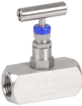
fig 522 naaldventiel inox PN420 1/4" - 1" bsp ANSI 6000 lbs huis : inox 316 teflon spindelafdichting
