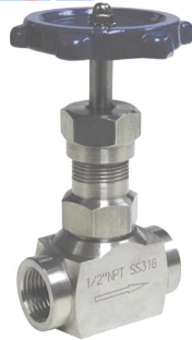
fig 523 naaldventiel inox PN210 1/4" - 2" bsp ANSI 3000 lbs huis : inox 316 teflon spindelafdichting
