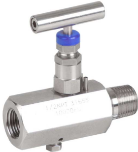
fig 525 naaldventiel inox PN420 MF 1/4" en 1/2" bsp ANSI 6000 lbs huis : inox 316 teflon spindelafdichting voorzien van aflaatopening temp. : -54°C/+250°C geschikt als manometerkraan
