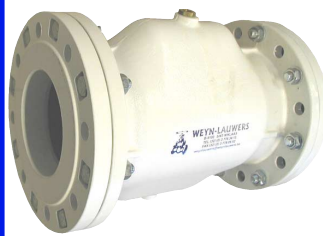
fig 686 mofafsluiter aluminium DN 40 - DN 200 huis : aluminium mof : natuurrubber flenzen volgens PN10 max. werkdruk 6 bar stuurdruk : = werkdruk + 2 bar temp. : max. +80°C voedingsgeschikte rubber op aanvraag
