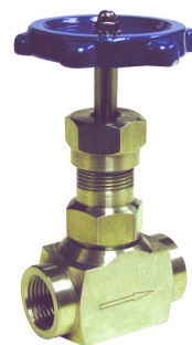
fig 521 naaldventiel staal PN210 1/4" - 1" bsp ANSI 3000 lbs huis : staal A105 teflon spindelafdichting naald : inox 316 temp. : -20°C/+250°C
