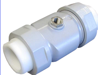
fig 685 mofafsluiter aluminium 1/2" - 2" bsp huis : aluminium / aansluitingen : POM mof : natuurrubber max. werkdruk 6 bar stuurdruk : = werkdruk + 2 bar temp. : max. +80°C voedingsgeschikte rubber op aanvraag
